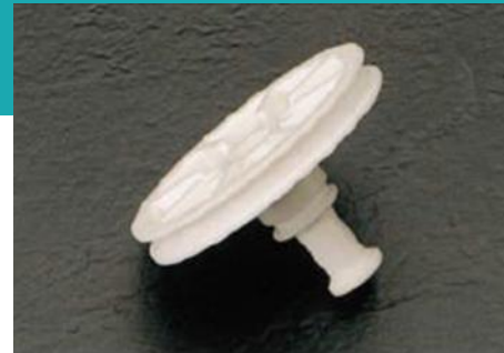
ブレーキ倍力装置の ピストンリレー
